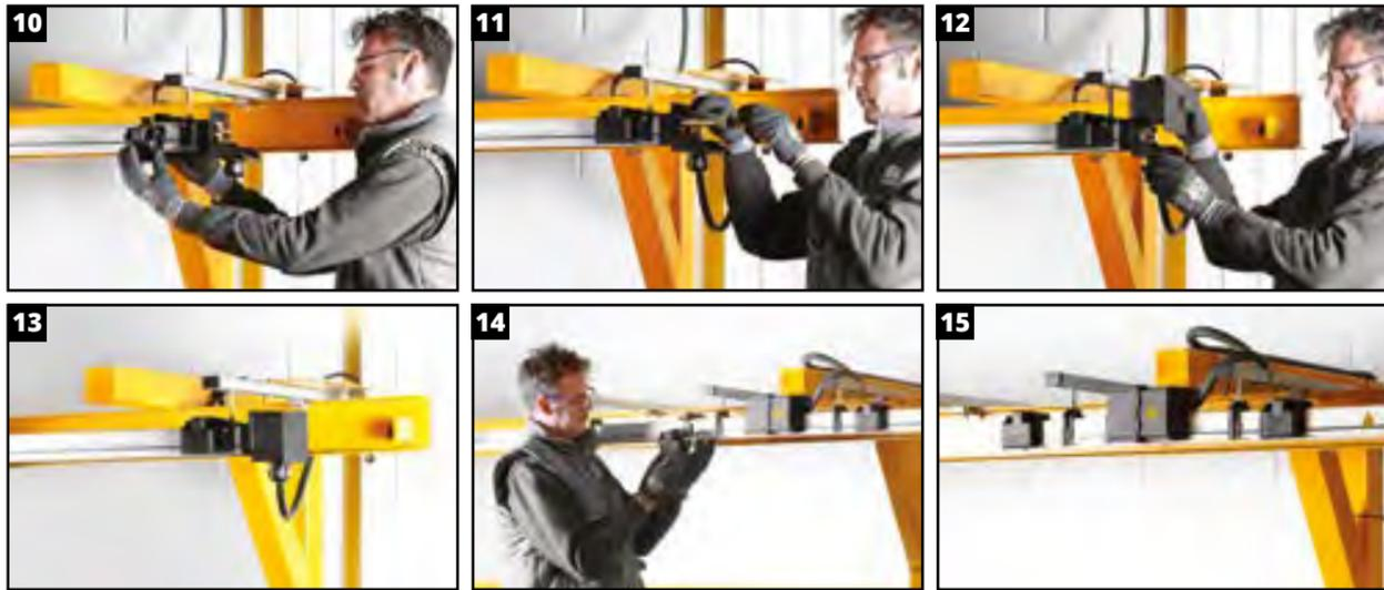
**7** Introducir en el extremo de la línea, o bien por alguna unión de perfiles, el carro colector, presionando manualmente las escobillas, y teniendo en cuenta que tiene una única posición: La escobilla marcada como "Tierra" tiene que ir colocada del lado del perfil PVC señalado con rayas en blanco y negro, y con pegatina "RG" (Foto 16).
