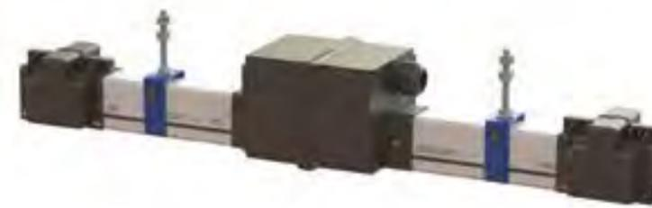
Conjunto formado por una caja de acometida intermedia con un prensaestopas M25x1,5, dos tramos de barra conductora de 300mm cada uno, dos punto fijos RGMM05, así como dos empalmes de línea RGMM02.
