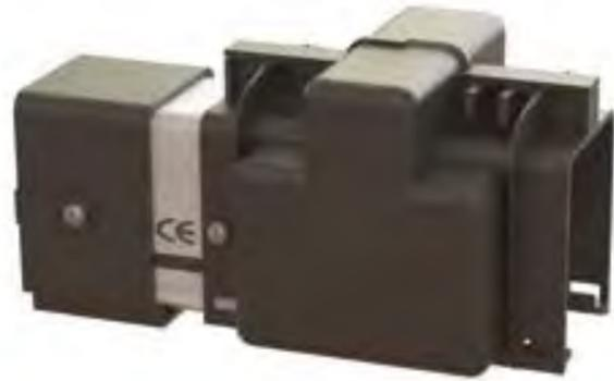
Conjunto formado por la propia tapa extrema con un tramo de barra conductora de 100mm y un empalme de línea RGMM02 provisto de unos tornillos rosca chapa para su fijación a la barra conductora, asegurando de este modo su amarre al sistema.
